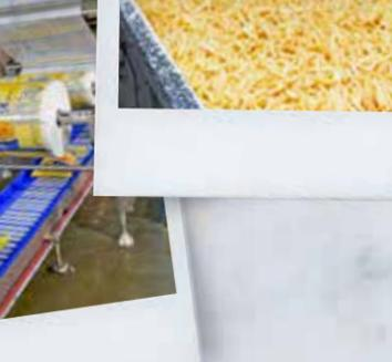
1 | aanvoer aardappelen 2 | kwaliteitscontrole 3 | reinigen (wassen & drogen) 4 | sorteren 5 | schillen (stomen onder hoge druk)
